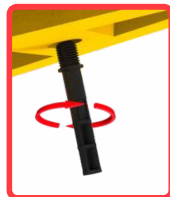
Colocación de pernos
