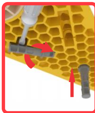
Colocación de pernos
