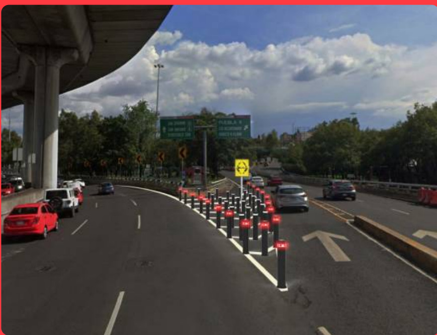
ISLA DE VIDA; Bolardos internos macizos flexibles Flechero abatible al impacto
